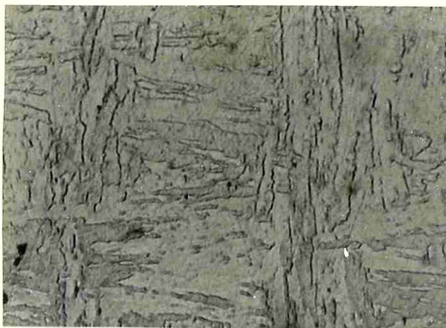
Figura 12 - Superfície de amostra 410 AC nitretada superficialmente. Martensita em ripas. Ataque Villela. Aumento: 600 X.
